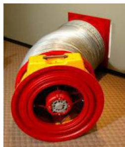
Accessorio per la misura nei canali di ventilazione
