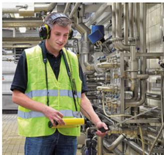
Disponibile in optional con il sensore a idrogeno LD6000. LD6000 è eccellente nella localizzazione di perdite di forming gas tipo 95/5 – composto al 95% di azoto e al 5% di idrogeno.
