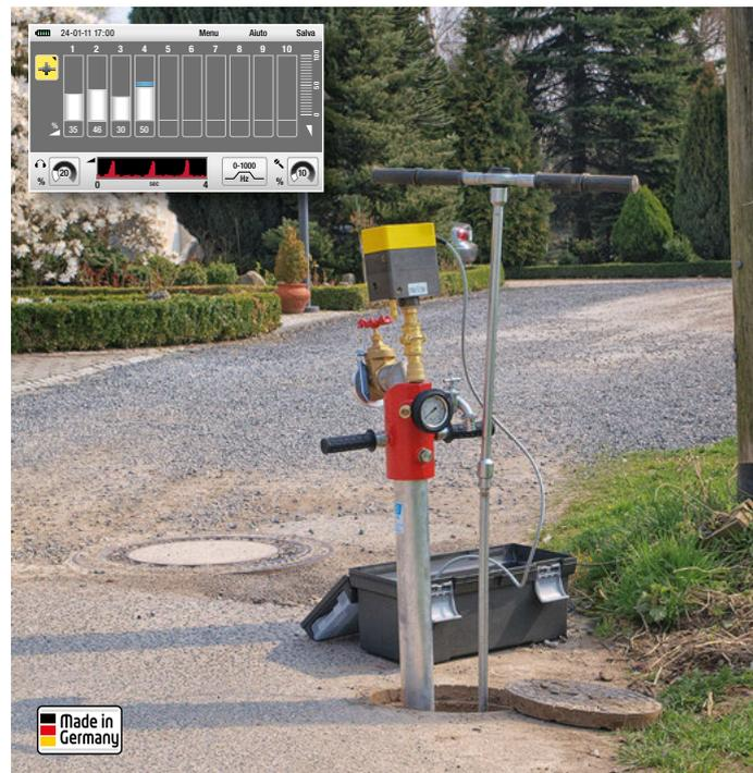
Questo generatore d'impulsi è ottimale per l'uso combinato con lo strumento di misura LD6000.
