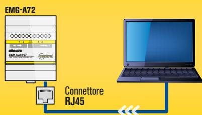
Collega un PC, sul quale avvierai **EMG Tool**, direttamente al connettore modulare **RJ45** del dispositivo utilizzando il cavo adattatore **USB** o **RS232**
