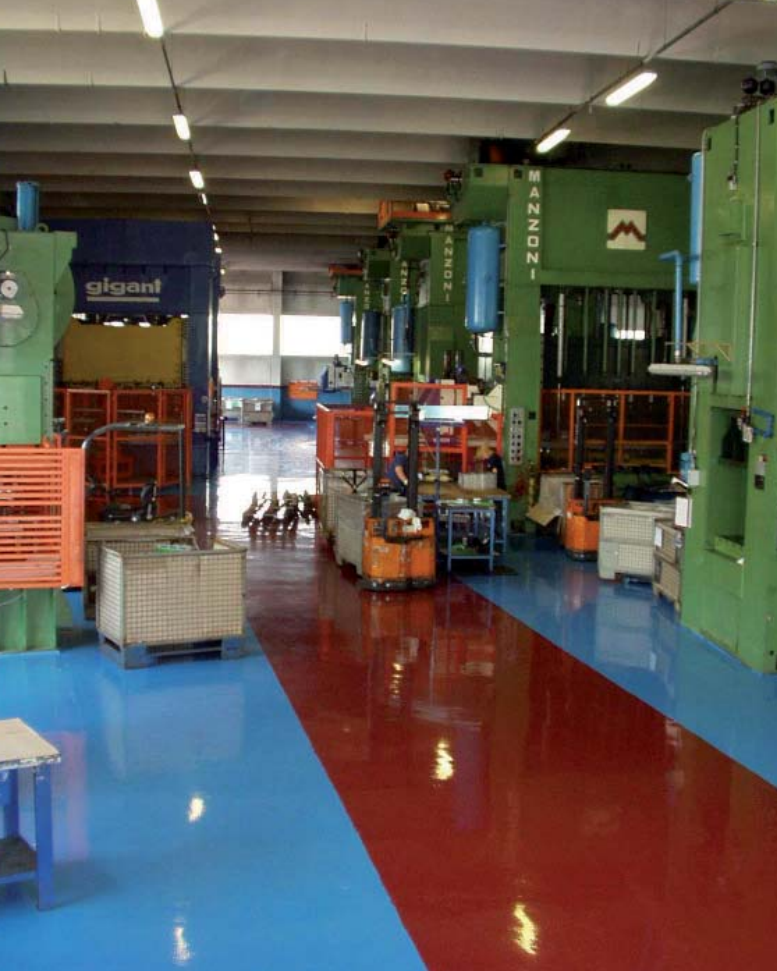
Stabilimento Componenti Faist - Montone (PG) - Italia Prodotti usati: MAPEFLOOR SYSTEM 33 MAPEFLOOR SYSTEM 34
