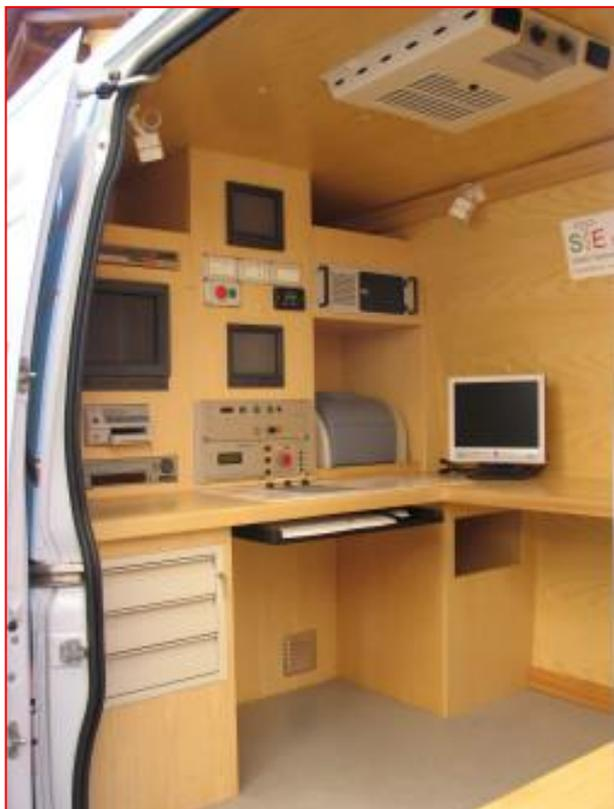
Disponiamo di una gamma di telecamere con cui possiamo ispezionare diametri a partire dai 25 mm fino a 2800 mm in una soluzione unica fino a 600 metri.
