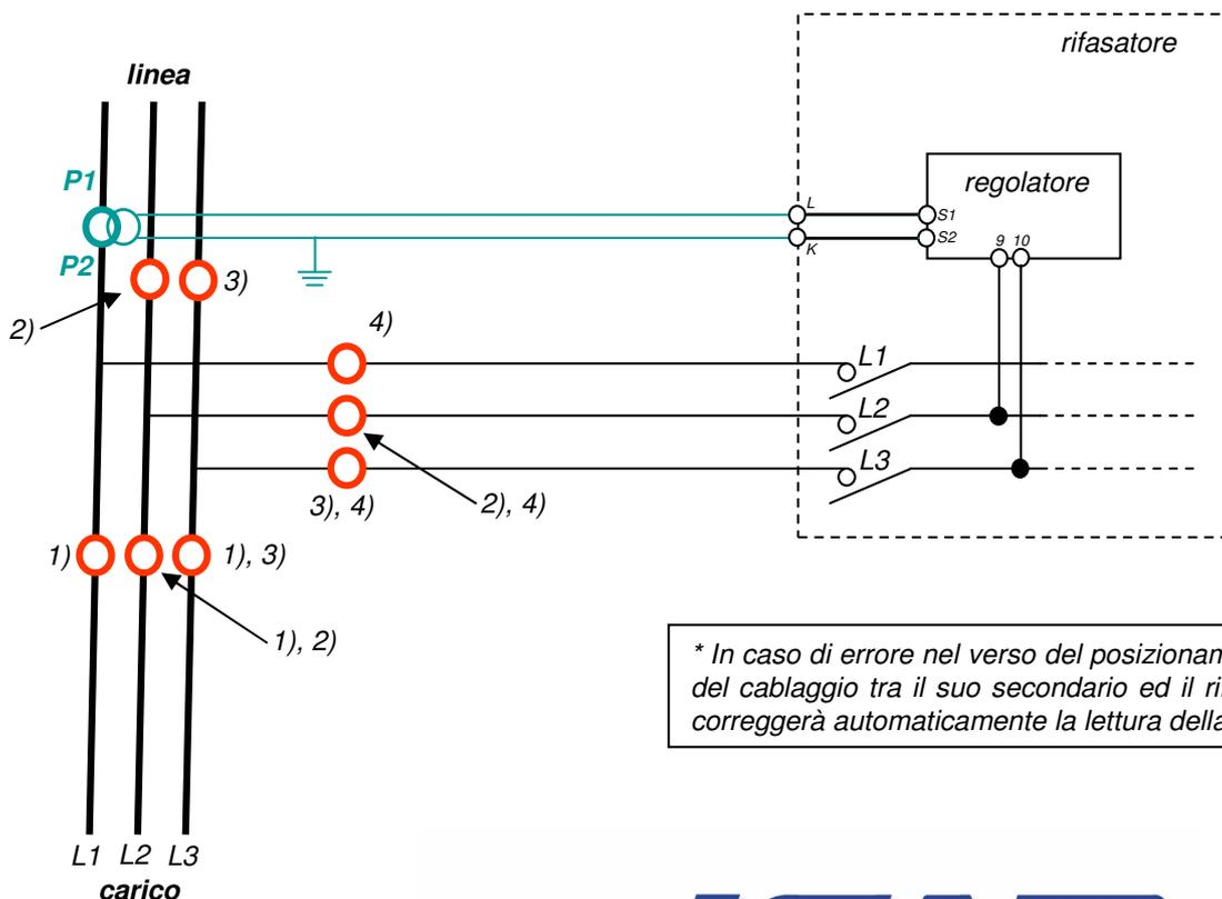
\* In caso di errore nel verso del posizionamento del TA o di inversione del cablaggio tra il suo secondario ed il rifasatore, il regolatore ICAR correggerà automaticamente la lettura della corrente.
