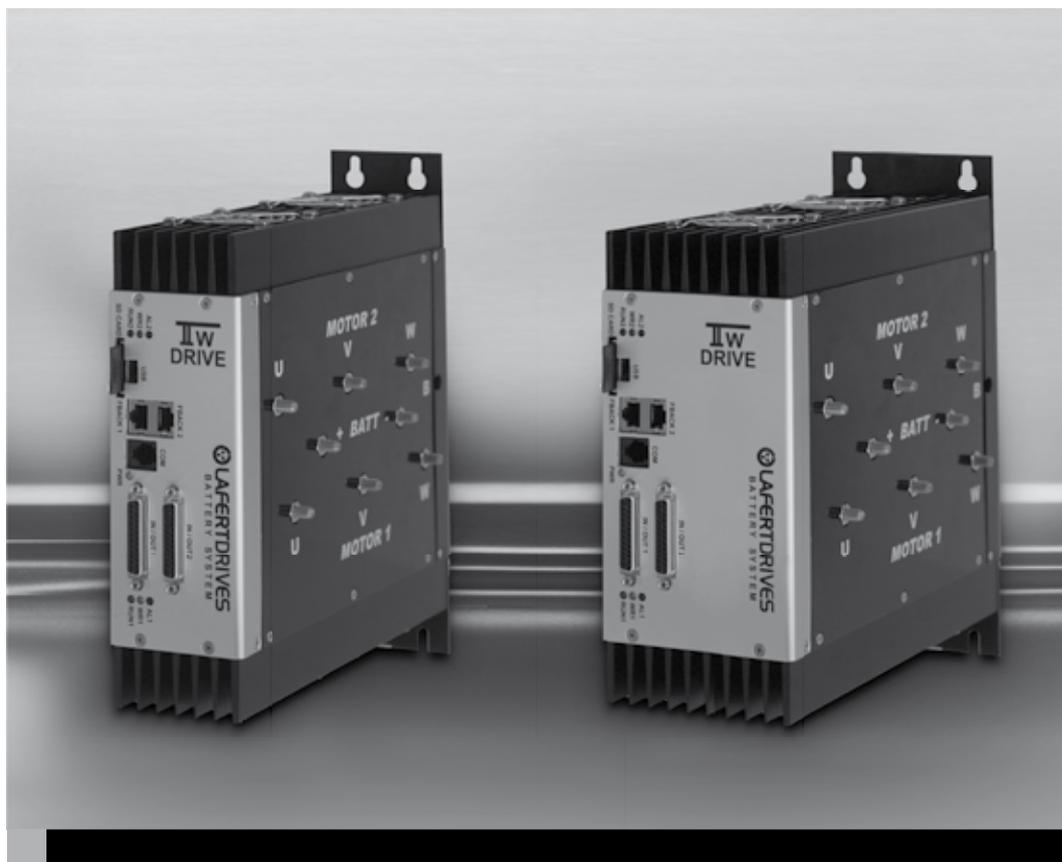
Azionamento a doppio canale in formato a libro, per alimentazione a batteria (24Vdc, 48Vdc, 96Vdc). Controllo simultaneo di due motori con un solo drive in velocità, coppia, posizione. Possibilità di sincronizzazione matematica tra i due motori.
