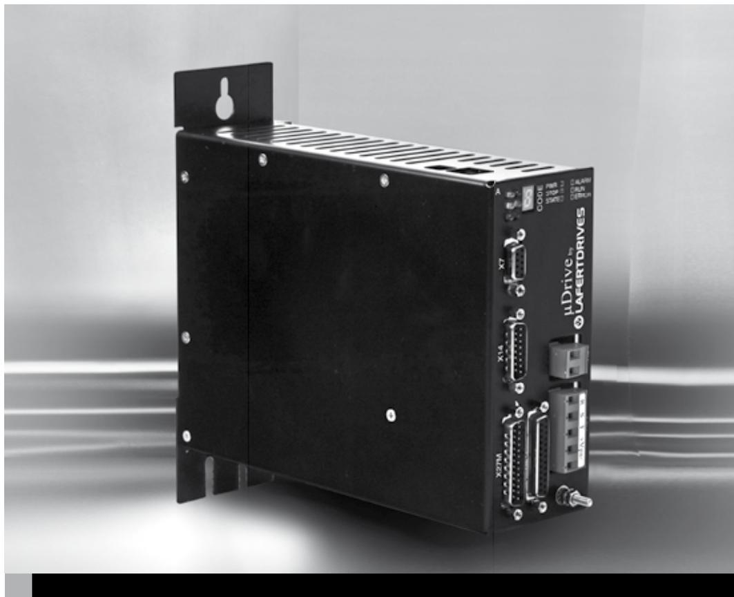
Azionamenti compatti monoasse in formato a libro, comando sinusoidale con alimentatore, gruppo di recupero e circuiti di precarica integrati. Alimentazione a 230/480 Vac trifase e monofase  $\pm 10\%$ , correnti di uscita fino a 15/30 Arms.
