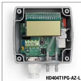
insensibili alla posizione di montaggio. Il circuito di autozero compensa l'invecchiamento e lo scostamento dello zero del sensore al variare della temperatura: in pratica consente di eliminare la manutenzione.
