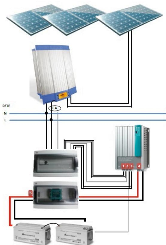
Quando l'impianto produce energia in eccedenza, il sistema carica in automatico le batterie. Nelle ore serali, commuta automaticamente l'alimentazione delle utenze domestiche dalla rete alle batterie, tramite un inverter che fornisce tensione e frequenza 230 V stabilizzata, con onda sinusoidale pura.
