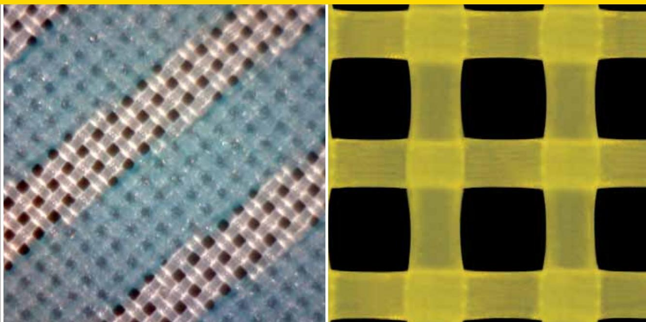
**■** Los tejidos **SUPREX** de monofilamento de poliéster han sido diseñados específicamente para realizar marcos de serigrafía.
