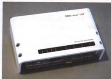
Particolare dell'architettura Rfid operativa in GSE: controller Long Range LRU3500 (a) e controller RedWave PRU50 RFID di Softwork (b)
