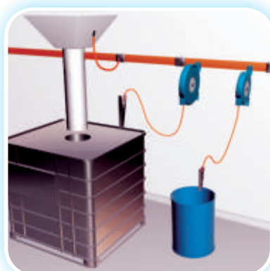
Messa a terra di IBC e fusti metallici con pinze e avvolgicavo retrattili (ulteriori dettagli sul retro)
