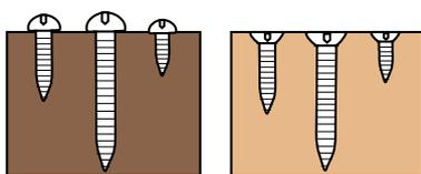
Avvitatura eseguita con regolazione grossolana della coppia di serraggio
