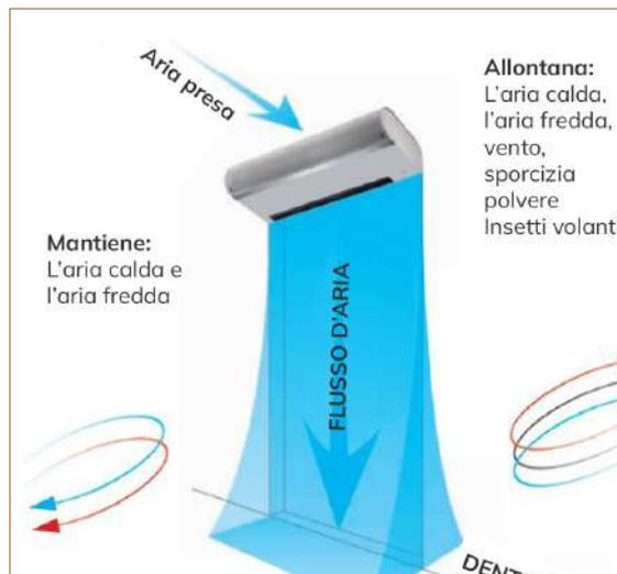
\* L' altezza massima di installazione dei moduli è puramente indicativa. Il dimensionamento delle lame d'aria deve considerare la eventuale presenza di correnti d'aria nel locale derivante ad esempio da esposizioni dell'edificio, correnti d'aria esistenti o estrazioni d'aria particolarmente intense che ne potrebbero influenzare negativamente la resa. In particolare i dimensionamenti vengono eseguiti considerando una velocità di ingresso aria dalla porta uguale o inferiore a 0,5 m/s.
