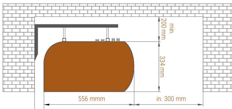
La barriera d'aria può essere installata solo in posizione orizzontale e sarà posizionata il più possibile vicino al bordo superiore della porta. Per un funzionamento ottimale, la larghezza della barriera dovrebbe superare la larghezza della porta di 100 mm su entrambi i lati. Ri-spettare le distanze indicate nel disegno a fianco. Per appendere la barriera, usare le apposite staffe.
