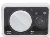
Il tipo di controllo commutatore manuale usa normali cavi 230 V, che sono esclusi dalla fornitura. La regolazione della portata aria avviene tramite 3 diverse velocità. Nello specifico la regolazione della barriera con riscaldamento elettrico (se presente) avviene su 2 livelli (spento/livello 1/livello 2), mentre per il funzionamento del riscaldatore ad acqua è presente la regolazione On/Off. Possibilità di regolazione in base a segnali esterni\*.
