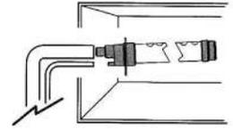
DP\*: distributore lineare di vapore (ingresso Ø 22 mm, Ø 30 mm, Ø 40 mm), per applicazioni in condotta
