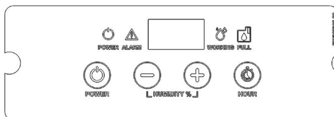
**Power:** Questo LED è acceso se l'apparecchio è abilitato a lavorare (tramite tasto ON-OFF) Se la macchina è collegata all'alimentazione elettrica il display indica il valore dell'umidità relativa.
