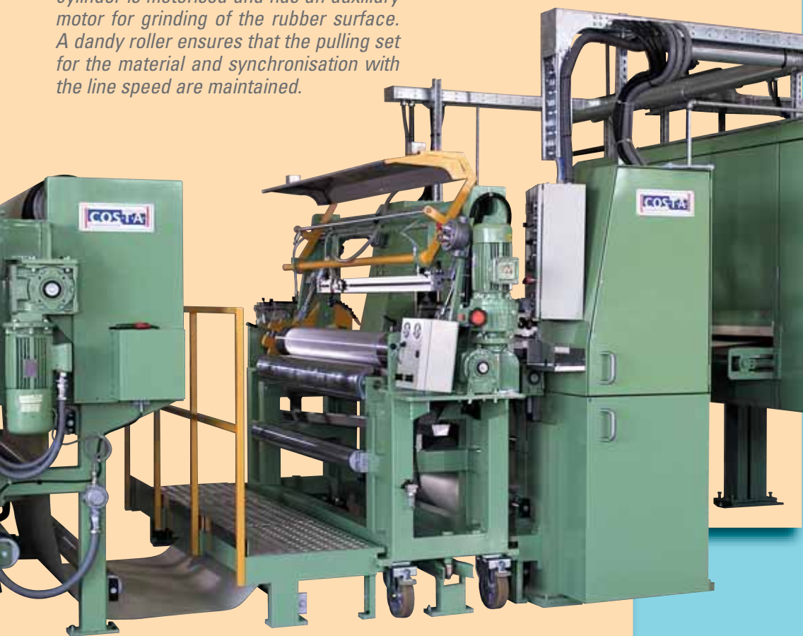
Spalmatrice a cilindro inserita in linea, davanti ad una spalmatrice a lama
