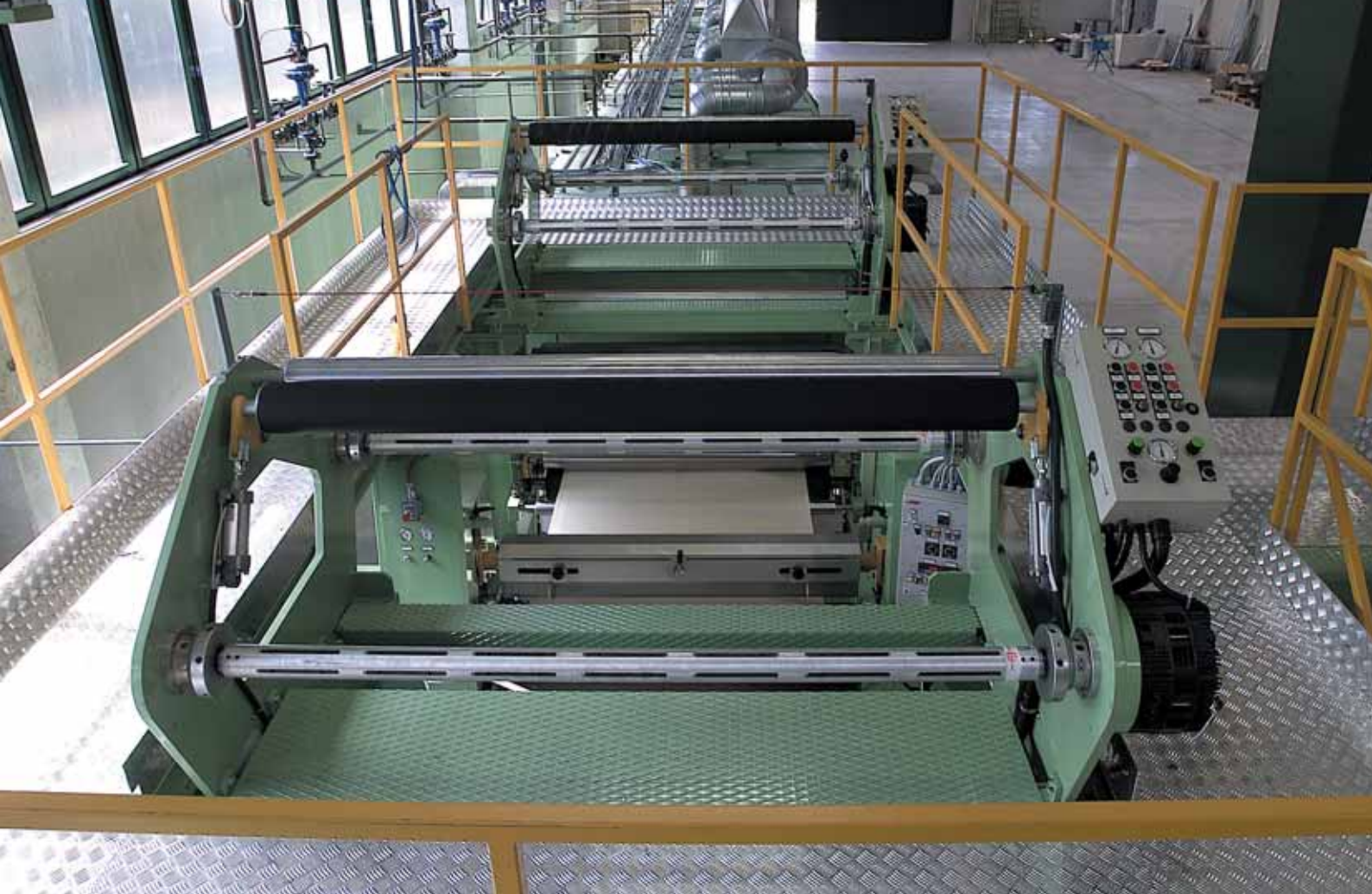
Accoppiatori a secco e ad umido di un impianto di spalmatura a 4 teste. Particolare degli svolgitori.
