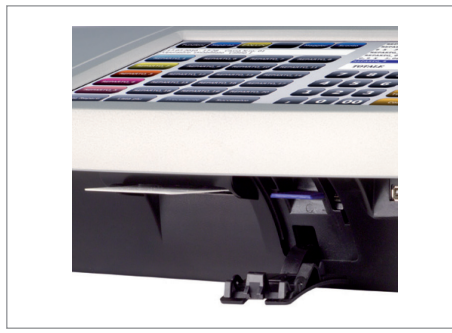
Giornale di fondo elettronico, USB master e lettore chip card integrati
