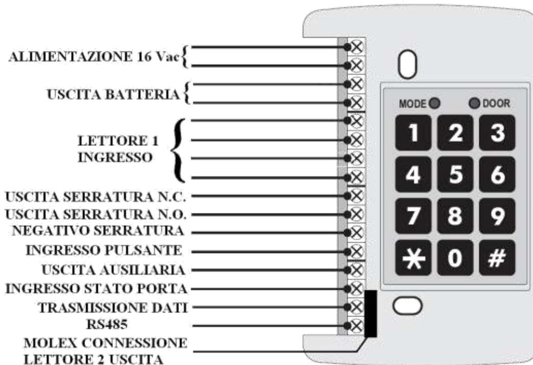
Schema filare di collegamento di una centralina che controlla una porta con due lettori e di una centralina che controlla due porte con due lettori della serie AC 215, 225, 525.
