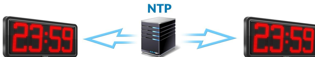
Orologi sincronizzati da server NTP locale (LAN)
