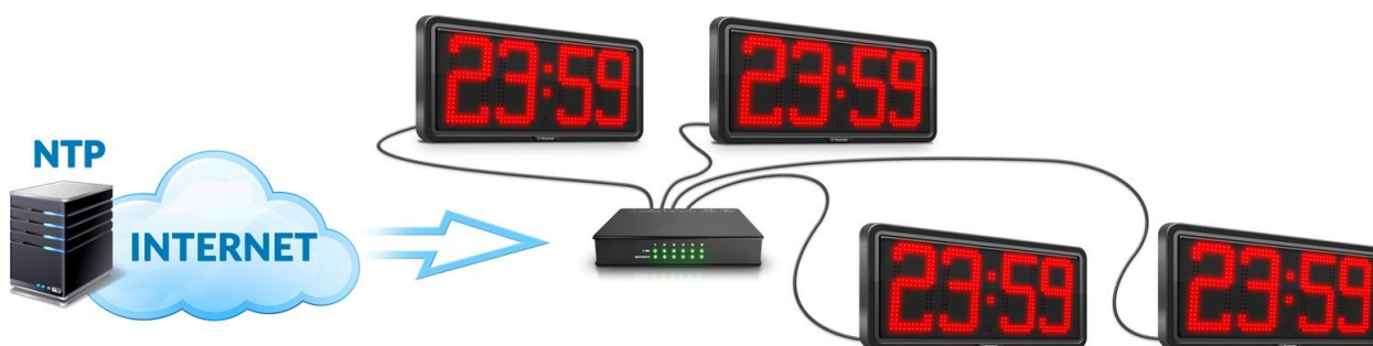
Orologi sincronizzati da server NTP remoto (Internet)
